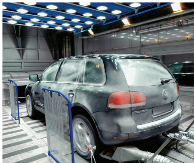
Prueba completa del vehículo Temperatura/Humedad/Luces/Dyno combinados
